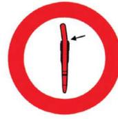
Eğilme, bükülme durumunda kanca kullanımdan çıkarılmalıdır. Kimi kaynaklar 10° ye kadar olan eğilme ve bükülmeleri tolere edebilmektedir.
