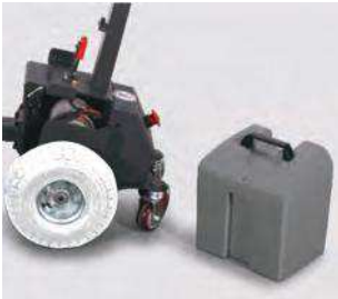
Kolay, güvenilir ve emniyetli akü deęişimi Easy, safe and reliable battery exchange TWT01
