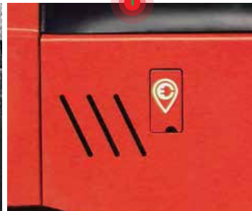
Kısa duruşlarda aracı hızlı şarj etmeyi sağlayan şarj bağlantı noktası
